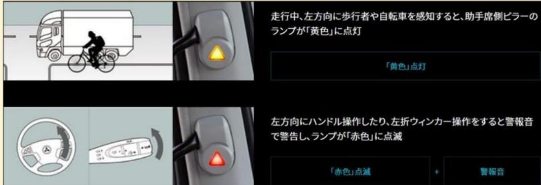
左折巻き込み事故、左車線変更時の側方の衝突事故の防止するため、側方の物体（車両・自転車等）を検知、車両の通過範囲を予測し、そのまま走行すれば衝突の可能性が高いと判断した場合には運転者に衝突を回避するよう警報する機能。
