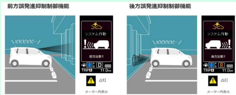
アクセルペダルの誤操作が疑われ、かつ障害物への衝突が予測される場合に、エンジン出力制御やブレーキ制御などによって急発進、急加速を抑制する機能。
