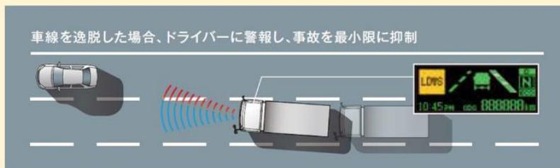
走行車線からの逸脱を防止するため、走行車線を認識し、車線から逸脱した場合あるいは逸脱しそうになった場合には、運転者が車線中央に戻す操作をするよう警報する機能。
